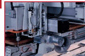
Lama con inclinazione di 45° da CN Saw blade for the cut of 45° for the other end of the top fram Агрегат "лезвие" с инклинацией +/-45° управляемый ЧПУ
