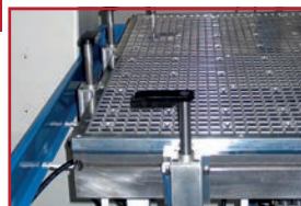
Tavola di alluminio con bloccaggi rotanti Aluminum table and rotary pistons Алюминиевый стол, Система для блокировки арок
