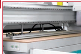
Barra di scarico automatico Automatic unloading system of the panels Консоль для автоматической разгрузки панелей
