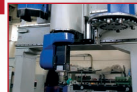
Testa 5 assi con rotazione +/-225° e +/-100° da CN Operating head 5 axis with +/-225° and +/-100° rotation controlled by NC - Пятиосевой агрегат с вращением +/-225° и +/-100° управляемый ЧП
