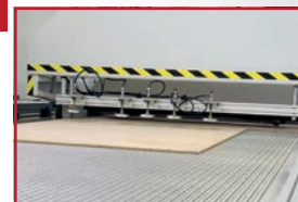
Ventose per traino pannelli Vacuum cups for panels draft Вакуумные фиксаторы для перемещения панелей
