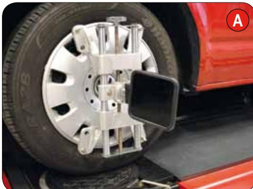
**Target leggero ad alta risoluzione** staccabile dalla staffa e compatibile con tutte le staffe Teco. Filtro infrarosso anteriore, per una elevata immunità ai riflessi solari.
