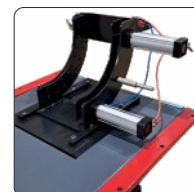
Calço de roda dianteiro amovível e ajustável
