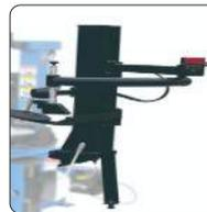
Facilita a montagem e remoção de pneus de baixo perfil/Runflat. Disco de elevação de pneus. Rolo de posição intermediária.
