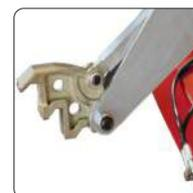
Mandril de fixação autocentrante com controlo hidráulico
