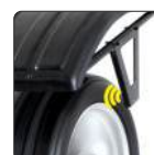
Medição da jante por Sonar
