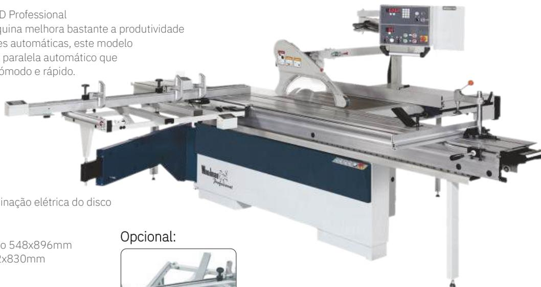
Eletrónica c/ subida, descida e inclinação eléctrica do disco
