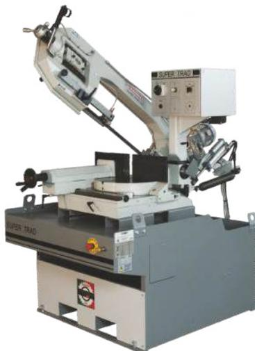
Descida assistida por cilindro hidráulico
