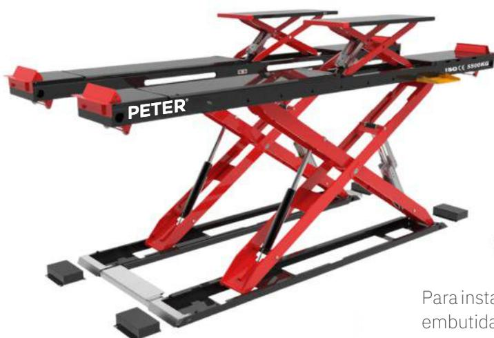
Elevador de tesoura de baixo perfil com instalação acima do solo ou embutida. Tem incluído macaco central com duplo cilindro e motor em alumínio sem sobreaquecimento. Monitorização do equilíbrio das plataformas (paragem automática). Sistema de segurança pneumático. Plataforma de 580mm /750mm (para todos os carros). Trás incluído a caixa de controlo.
