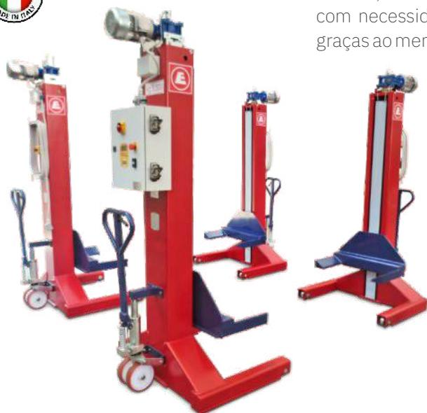
Elevador de 4 colunas independentes com sistema de nivelamento auto-elétrico, válvula de segurança e controlo de descida. Alta fiabilidade das colunas com necessidade mínima de manutenção e reparação. Eficiência energética graças ao menor consumo comparado com outros equipamentos equivalentes.
