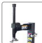
Braço horizontal com veio hexagonal de 36mm
