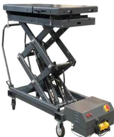
Plataforma de elevação electro-hidráulica
