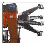
Mandril de fixação autocentrante com controlo hidráulico
