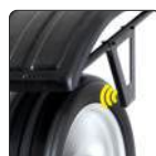
Medição da jante por Sonar
