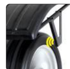
Medição da jante por Sonar
