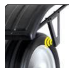
Medição da jante por Sonar
