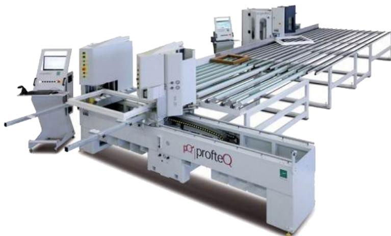
Linha automática com soldadura de 2 cabeças e grupo de limpeza para uma produção estimada de 120 quadros por cada 8 horas de trabalho com apenas um operador.
