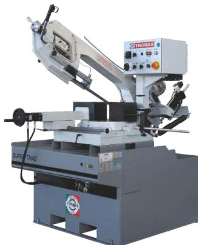
Descida assistida por cilindro hidráulico
