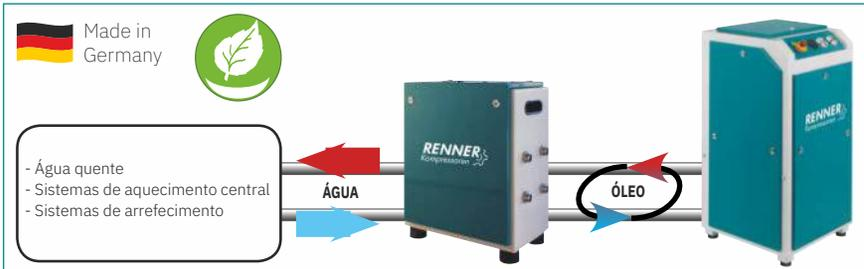
Recupere o calor gerado na produção de ar comprimido para aquecer água de forma eficiente e sustentável.
