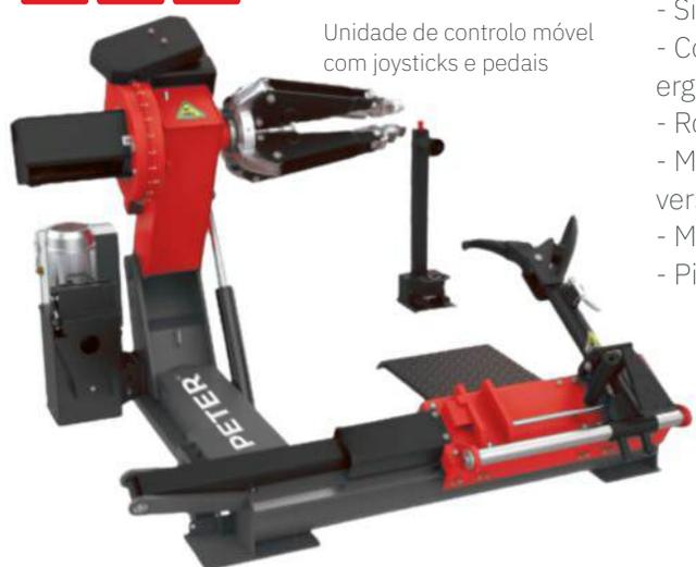
Máquina de trocar pneus para veículos pesados – Para rodas até 56".
