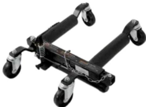
Macaco Hidráulico de Posicionamento de Veículos
