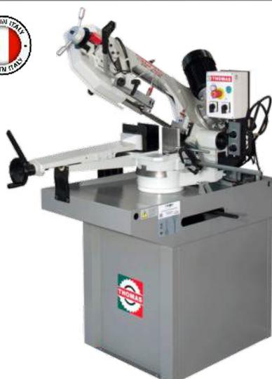
Descida assistida por cilindro hidráulico
