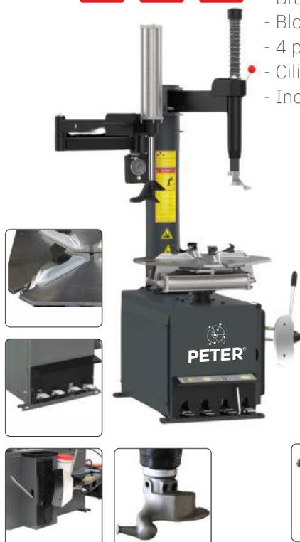
Máquina de desmontar pneus semi-automática com movimento lateral.
