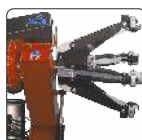
Mandril de fixação autocentrante com controlo hidráulico
