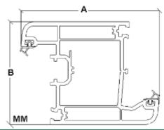
A max : 140 mm - B max : 200 mm - B min : 40 mm
