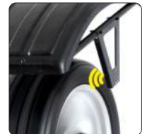
Medição da jante por Sonar
