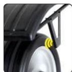
Medição da jante por Sonar
