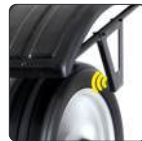
Medição da jante por Sonar
