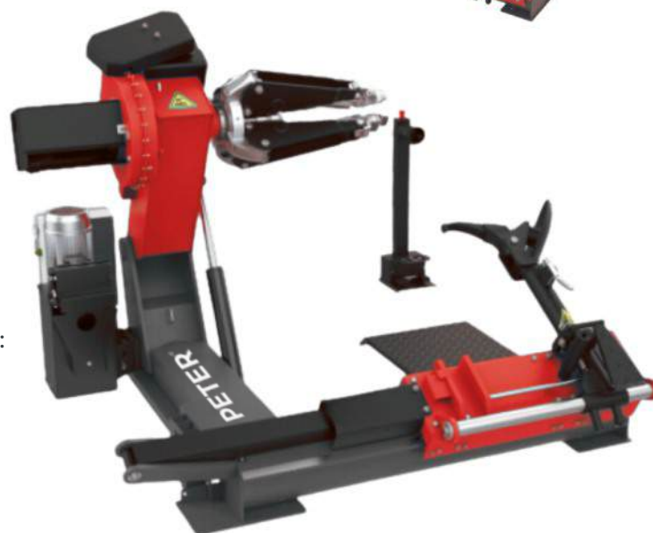
Mandril de fixação autocentrante com controlo hidráulico
