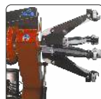
Mandril de fixação autocentrante com controlo hidráulico
