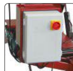
Caixa de controlo de 24V
