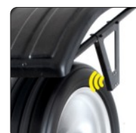
Medição da jante por Sonar
