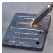
Limpeza do cordão de soldadura
