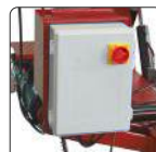
Caixa de controlo de 24V
