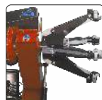
Mandril de fixação autocentrante com controlo hidráulico
